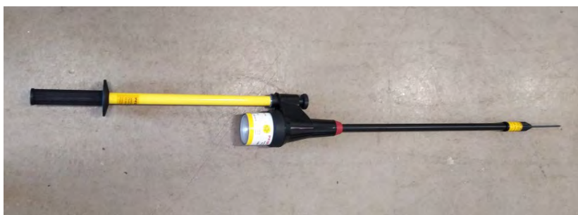
Figuur 3, Hoogspanningstester Pfisterer, met rechts de test-pen en links de isolatiestang
